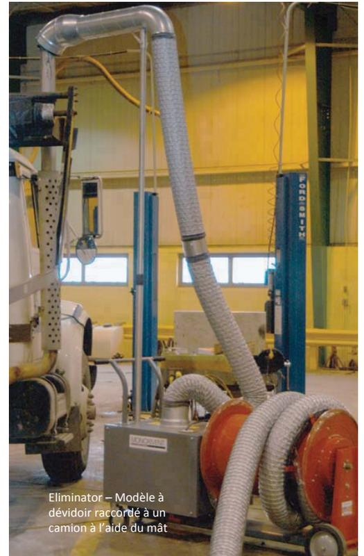
Eliminator – Modèle à dévidoir raccordé à un camion à l'aide du mât
