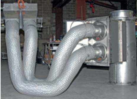
Base de cheminée d'échappement de tank M1 avec flexible
